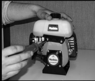
燃料タンク取り付け
